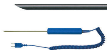
Sonde à piquer X12 Ø 3 mm x L = 130 mm 1/2 DIN 500 °C max.
