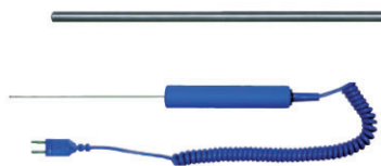
Sonde air/liquide X13A Ø 1,5 mm x L = 130 mm 1/2 DIN 850 °C max.
