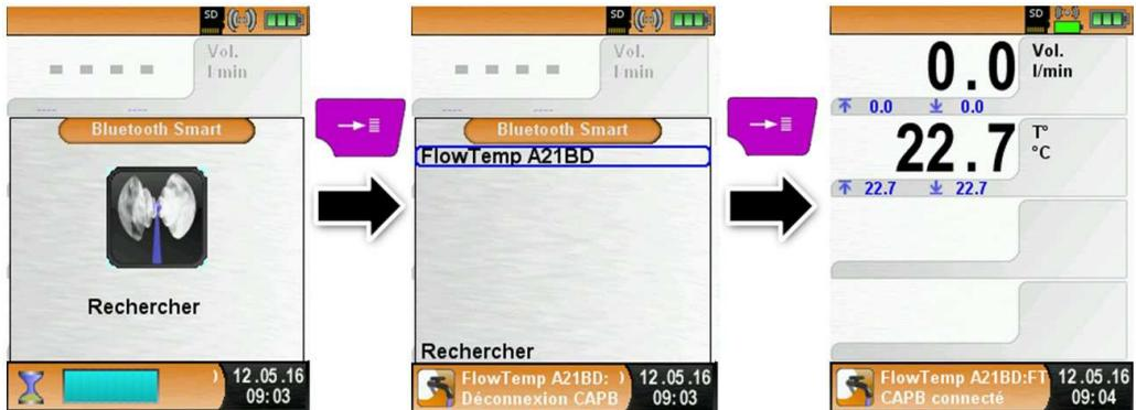
Lorsque la connexion est établie, la couleur de la LED sur le FlowTemp® ST passe du bleu au vert. Le FlowTemp® ST sélectionné est maintenant couplé avec l'appareil de la série BlueLine. À l'avenir, il se connectera automatiquement.
